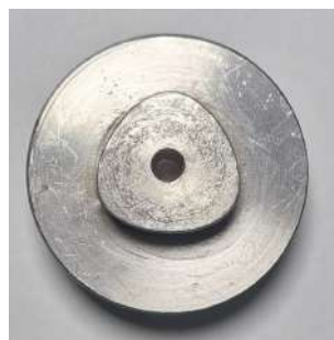
Рис. 2. РК-3 профильное соединение и схема нагружения втулки
