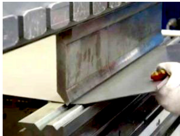
Рис. 1. Гибка листового металла на гидравлическом прессе
