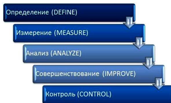
Рис. 3. Подход концепции бережливого производства, DMAIC Fig. 3. Lean Manufacturing Concept Approach, DMAIC
