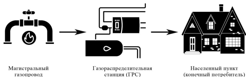
Рис. 1. Процесс газораспределения ГРС
