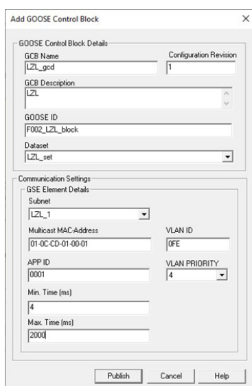
Рис. 6. Формирование блока контроля GOOSE-сообщений устройства МП РЗА вводной ячейки в ПО CET850
