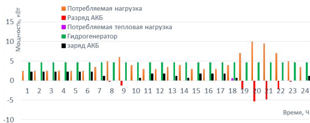
Рис. 6. Диаграмма энергетического баланса автономной системы электроснабжения с инверторной микроГЭС
