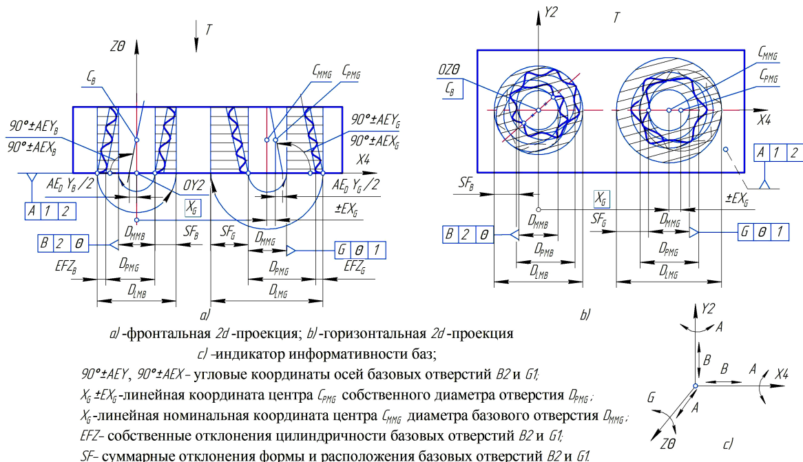
Рис. 3. Модели геометрических характеристик комплекта двух цилиндрических отверстий в функции основных конструкторских баз с информативностями 2inf и 1inf
