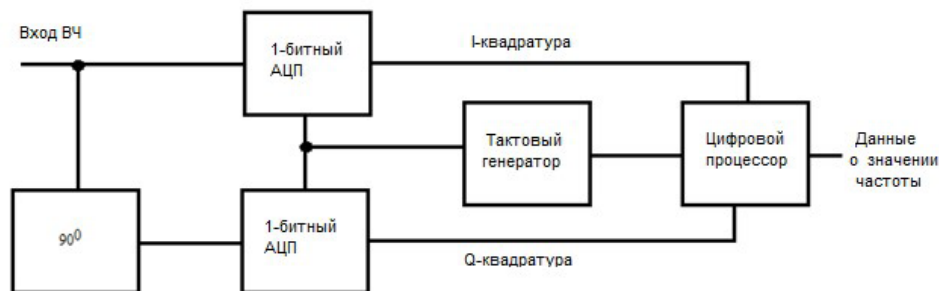
Рис. 1. Структурная схема цифрового измерителя частоты
