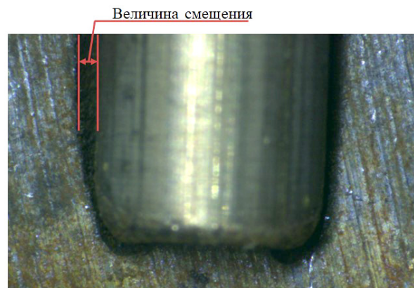
Рис. 3. Образование конусности в глухом отверстии
