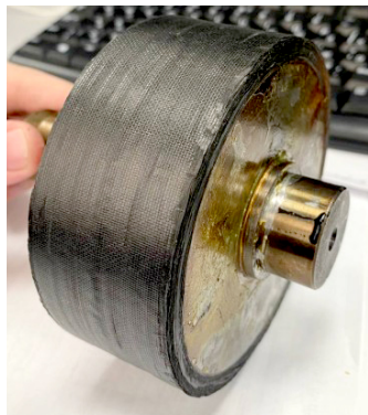
Рис. 7. Ротор испытательной оснастки с намотанным бандажом
