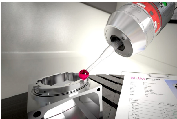
Рис. 1. Измерение размеров деталей с помощью контактной ИГ [1]
