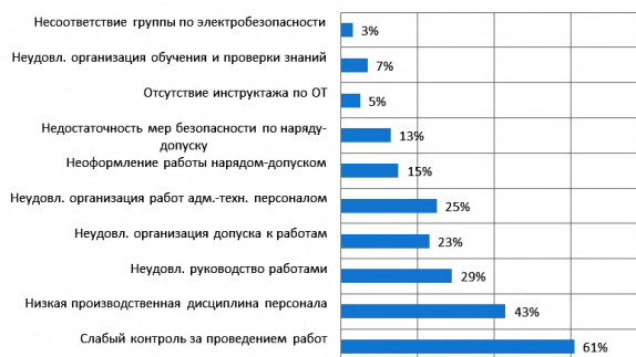
Рис. 6. Распределение организационных причин несчастных случаев, произошедших при эксплуатации электростанций, электрических сетей, тепловых установок и сетей и гидротехнических сооружений в 2023 г.
