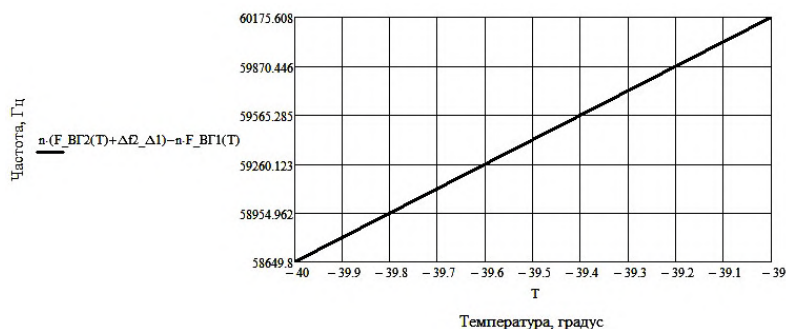
Рис. 13. Изменение разностной частоты (при использовании десятых гармоник частоты сигналов ВГ1 и ВГ2) в диапазоне температур от минус 40 °С до минус 39 °С
