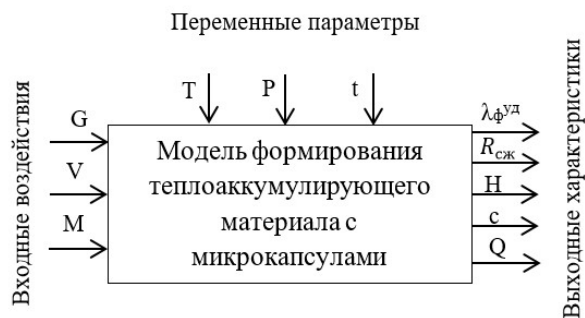
Рис. 1. Модель формирования теплоаккумулирующего материала с микрокапсулами
