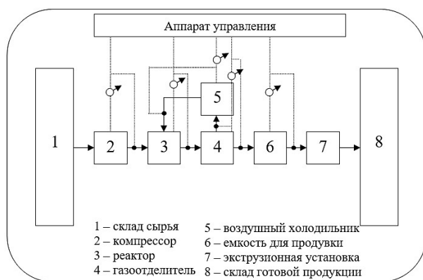
Рис. 3. Схема движения материальных потоков создания ПНД с применением автоматизированной системы КАНБАН на заводе ПППНД
