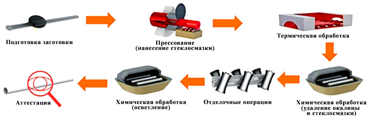
Рис. 1. Схема производства горячепрессованных труб Fig. 1. Scheme of production of hot-pressed pipes
