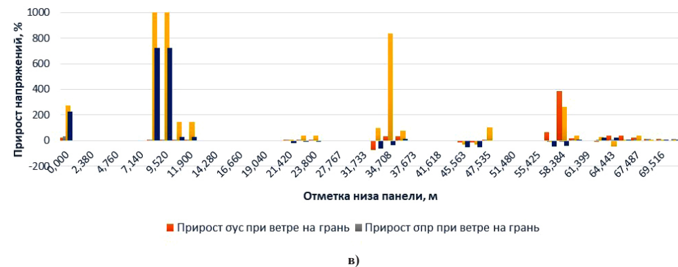
Рис. 5. Прирост максимальных напряжений: а — в элементах поясов при действии ветра в ребро; б — в элементах раскосов при действии ветра на грань; в — в элементах распорок Fig. 5. Increase of maximum stresses: а — in belts elements when the wind acts on the edge; б — in braces elements when the wind acts on the edge; в — in struts elements
