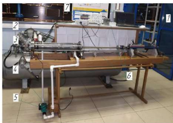
Рис. 2. Действующая модель длинноходового компрессора: 1 — силовой гидроцилиндр, 2 — ступень поршневого компрессора, 3 — ресивер, 4 — циркуляционный насос системы охлаждения, 5 — бак охлаждающей жидкости, 6 — система контроля положения поршня, 7 — система контроля параметров сжатого газа [5]
