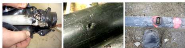
Рис. 2. Воздействие частичных разрядов на изоляцию
