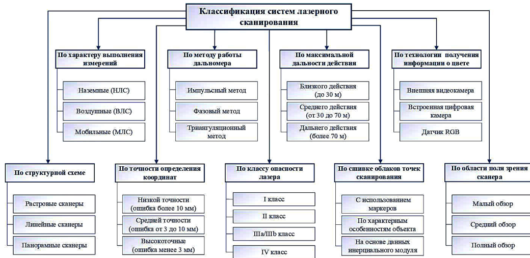
Рис. 1. Классификация систем лазерного сканирования Fig. 1. Classification of laser scanning systems
