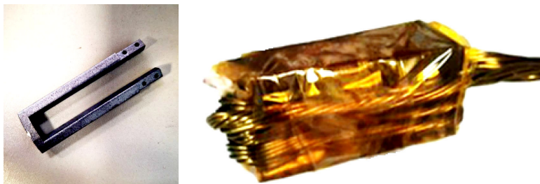
а) б) Рис. 4. Макет обмотки, изготовленной с помощью SLM: а — макет печатной обмотки; б — макет из провода ПНЭТ-имид Fig. 4. Winding layout manufactured using SLM: а — printed winding layout; б — layout made of PNET-imid wire
