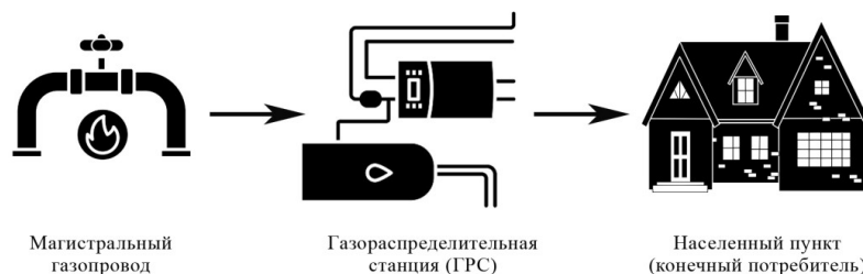
Рис. 1. Процесс газораспределения ГРС
