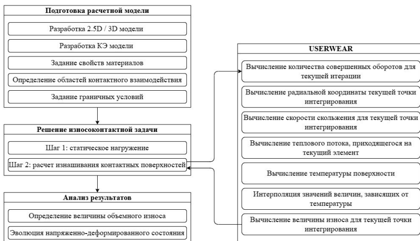
Рис. 5. Алгоритм методики расчета износа поверхности
