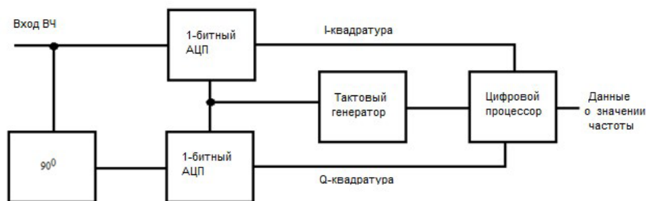
Рис. 1. Структурная схема цифрового измерителя частоты
