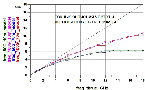
Рис. 5. Отклонение частоты измерителя без цифровой коррекции при разных тактовых частотах и уровнях ограничения в широком диапазоне частот
