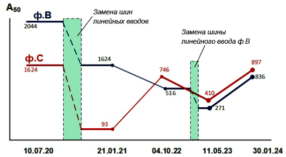
Рис. 11. Динамика изменений амплитуд спектральных линий A 50 для ф. В (ремонт всех фаз) и ф. С (ремонт одной фазы)
