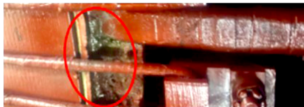
Рис. 4. Выход дегтеобразной массы в зоне вибрации и разрядов
