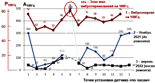
Рис. 10. Изменения амплитуды спектральной линии 100 Гц (виброперемещения) по точкам контроля (по часам) для измерений в ноябре 2021 г. (Q = 100 МВАр) — кривая 2, в апреле 2022 г. (Q = 89 МВАр) — кривая 3, а также виброэнергии на P 100 Гц [8, с. 11, 26] — кривая 1
