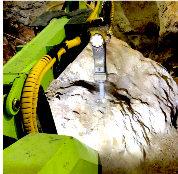
Рис. 7. Дробление негабаритов пикой гидромолота при производстве гранитного щебня в карьере Fig. 7. Crushing of oversize rock by hydromolot peak during production of granite crushed stone in the quarry
