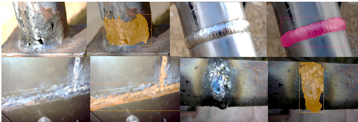
Рис. 6. Тестовая детекция и сегментация дефекта (YOLOv8+SAM).
