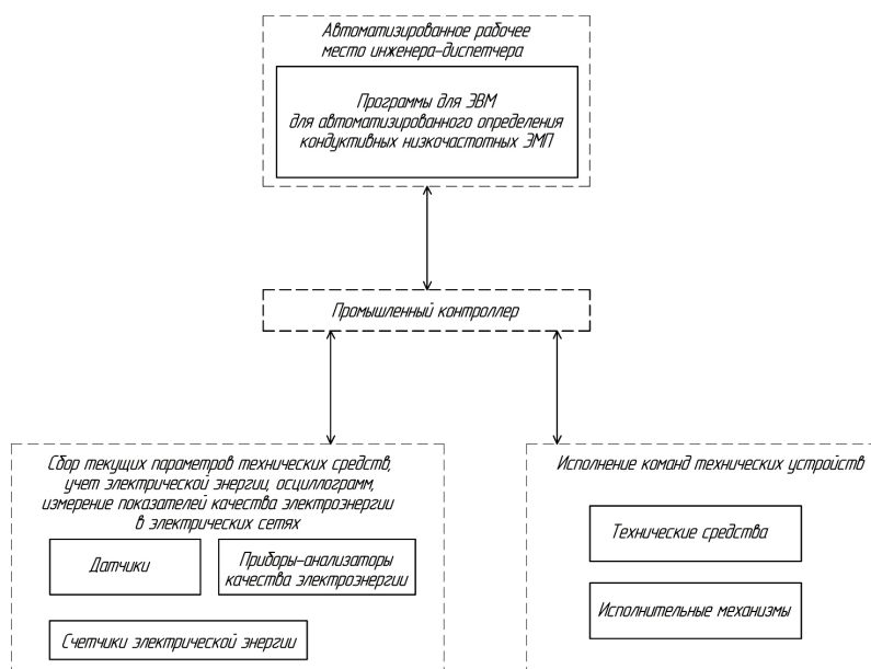
Рис. 6. Структурная схема метода автоматизированного определения кондуктивных низкочастотных ЭМП Fig. 6. Structural diagram of the method for the automated determination of the conductive low-frequency electromagnetic interference
