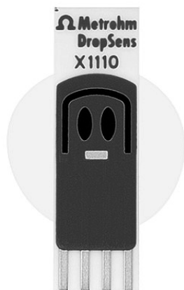
Рис. 3. Электрод, выполненный методом трафаретной печати с двойной электрохимической ячейкой
