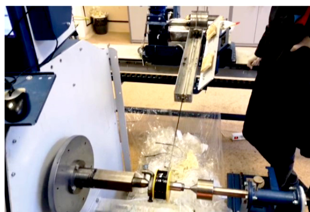
Рис. 3. Процесс намотки углеволоконного бандажа ротора
