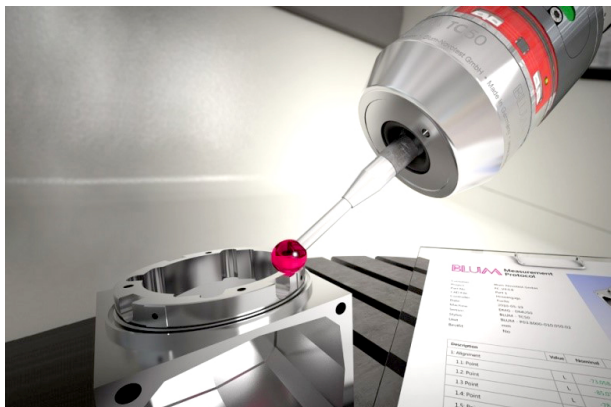
Рис. 1. Измерение размеров деталей с помощью контактной ИГ [1]
