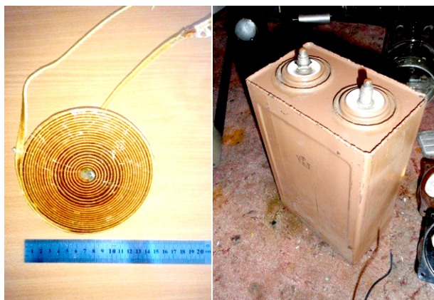
Рис. 1. Силовые элементы электроимпульсной системы взаимодействия: а) индуктор; б) высоковольтный конденсатор
